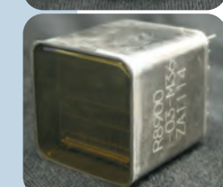
▲ Photomultiplicateurs La surface du PMT est de 26.2 mm 2 . Sa surface sensible effective est de 85%.
