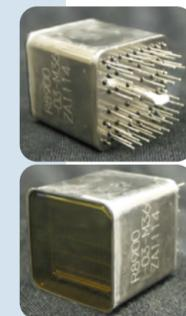
▲光電子増倍管 表面の85%に感度がある。26.2mm角、6×6ピセル。
