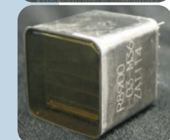
▲ Fotonowielacze Aktywna powierzchnia PMT stanowi 85% (z kwadratu o boku 26.2 mm) i dzieli się na 6x6 = 36 pikseli.
