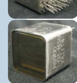
→ Fotonásobiče 85% povrchu PMT fotonásobičov tvorí aktívna plocha, majúca 6 x 6 pixelov s celkovou plochou 26.2 mm štvorcových.
