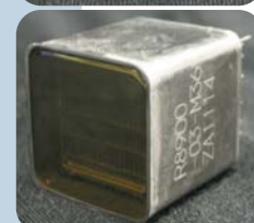
Fotomultiplicadores La superficie de los PMT tiene un área efectiva de 85%, con píxeles 6x6 con un área total de 26.2 mm cuadrados.
